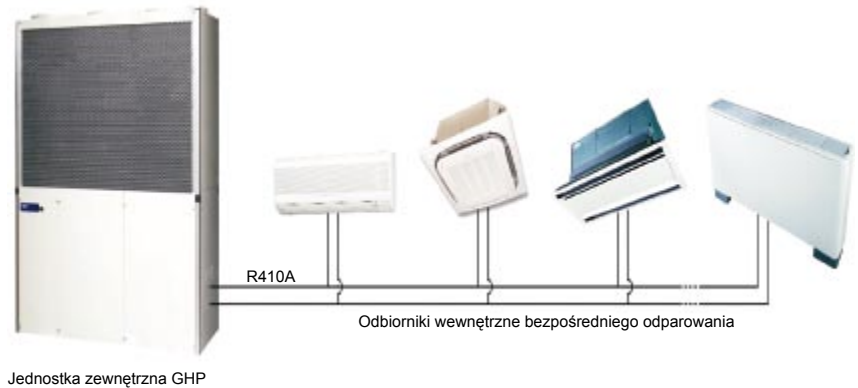
Rys. 7. Połączenie jednostki zewnętrznej GHP AISIN z różnymi typami odbiorników Dx bezpośredniego odparowania (typu Split)
