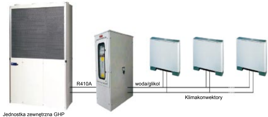
Rys. 8. Połączenie jednostki zewnętrznej GHP z odbiornikami układu wodnego poprzez stację wymiennikową AWS
